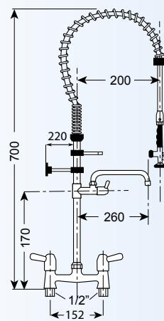
Possibilità di dotare tutti i rubinetti di valvole di non-ritorno e riduttori di portata - We are able to supply all our taps with non return valves and flow reducers
