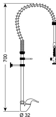
Installazione da banco Table installation Fixation sur plonge
